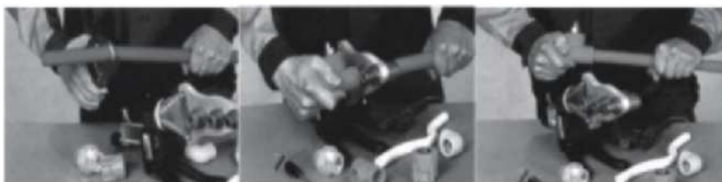
Postupak: zagrijavanje cijevi i fittinga → spajanje → hlađenje
